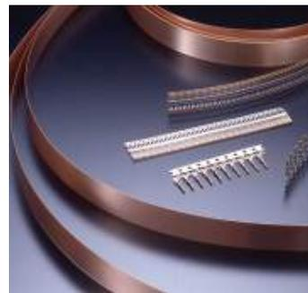
導電バネ材の中で最高強度を誇るベリリウム銅。寿命が長く信頼性の高い導電バネ材として、さまざまな電子機器や自動車のコネクタや端子、リレー、スイッチなどに使われています。
