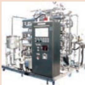
スタティックミキサーには、加熱・殺菌・冷却の用途もあります。直接加熱方式の「ノリタケクッカー」と間接加熱・冷却方式の「SM熱交換器」。これらを組み合わせて構成された「ノリタケ連続加熱殺菌冷却システム」は様々な食品の加工に使われています。
