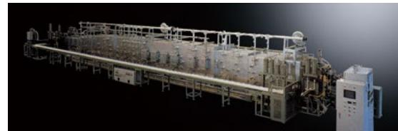
セラミックス、電子部品、二次電池材料、ガラス、粉体などを所定の温度、雰囲気で処理(脱バインダー、加熱、焼結など)する設備です。
