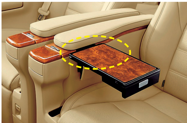
自動車の格納式テーブルに、当社FPDシリーズが採用されております。FPDシリーズで動きをコントロールする事により、安全で静かな車内空間を実現しております。
