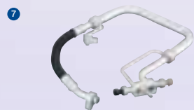
エアコンホース
