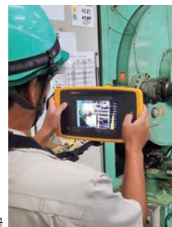
超音波カメラによるエア漏れ箇所確認作業風景
