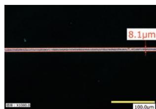
めっき処理後のガラス基板断面図。 めっきによりガラス基板上に微細配線形成
