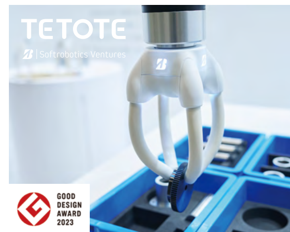
TETOTE 提携するアセントロボティクス社のAIソフトウェアを組み合わせることで、様々なものをうまく掴めるソフトロボットハンド
