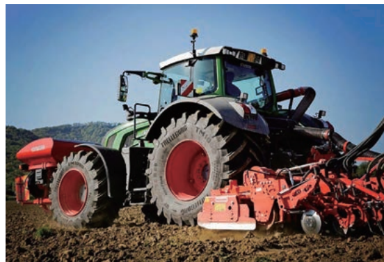
PFO規格適合タイヤを装着した農業機械
