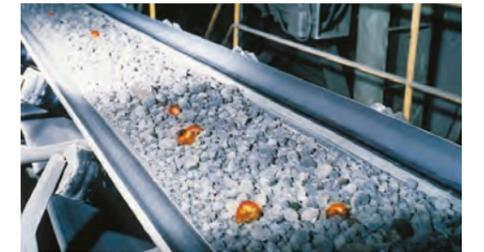
平塚製造所で製造している難燃中温耐熱性コンベヤベルト「FLAME GUARD #2110」
