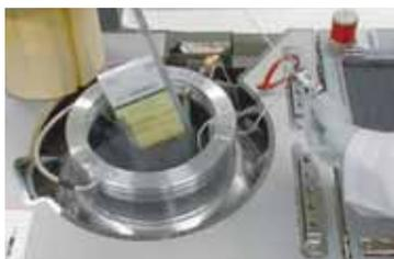
液体窒素を用いた「超低温保管・輸送カートSDDU」
