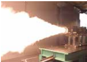
固体推進薬燃焼試験の様子
