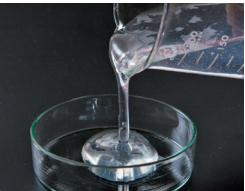
パルプをナノ解繊したセルロースナノファイバー (CNF)
