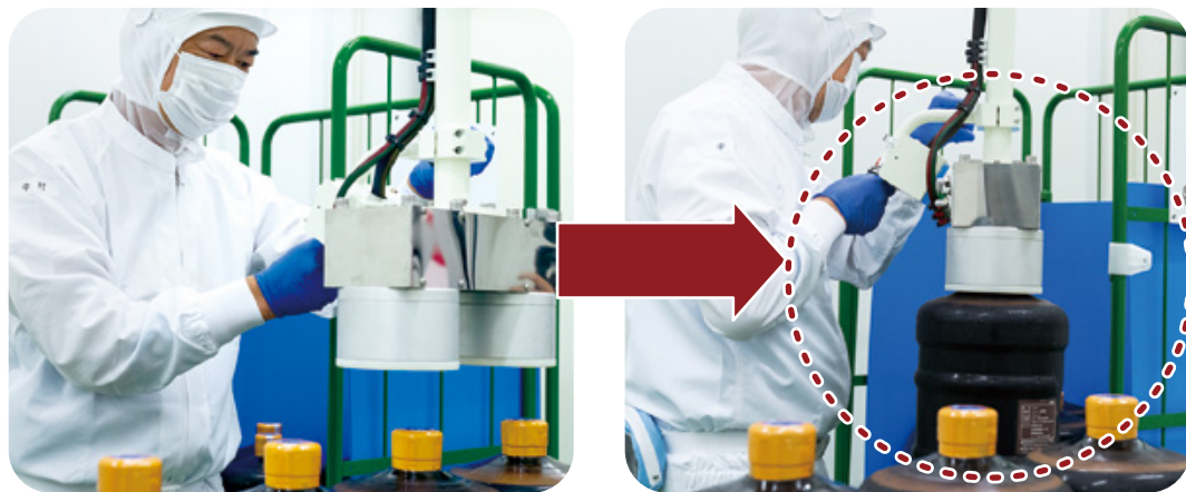
関東・九州のコーヒー工場のパワーアーム。2工場合わせて1,800本/日以上 of ボトル運搬を支える
