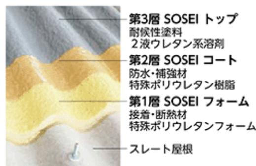
注:SOSEIの1層目の断熱層により、建屋内が夏場は涼しくなり冷房効率を高め、冬場は保温効果により暖房効率を高める効果。
