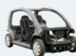
熱可塑性CFRPコンセプトカー
