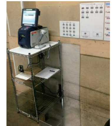
廃棄物計量器設置の例：廃棄物保管庫の前に設置し、部門ごと、品目ごとに漏れないように計量します。
