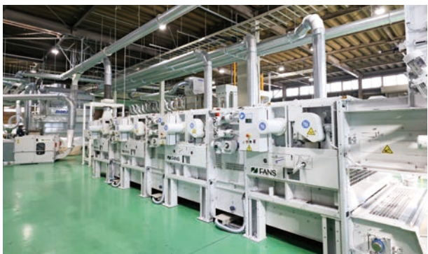
FANS石岡工場に導入された最新の反毛機械
