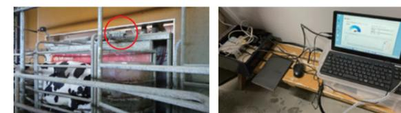
搾乳ロボットに設置したサーモニメタン(赤丸の箇所) 測定データの収集
