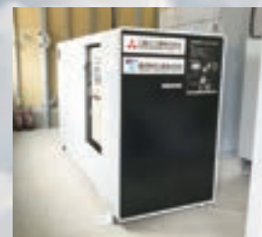
水素サプライチェーン実証 プラント水電解装置を納入
