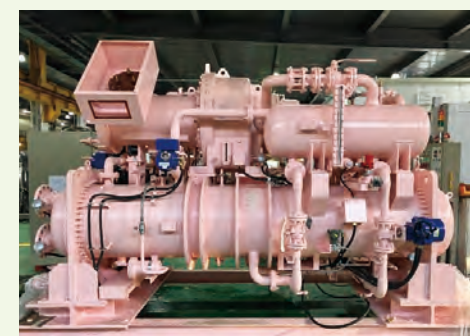
非常用ターボ冷凍機
