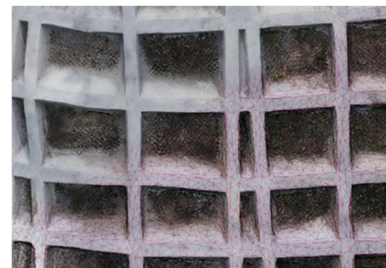
点群データを用いた法枠工出来形計測例
