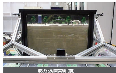
液状化対策実験（前）
