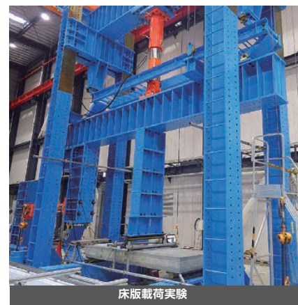
床版載荷実験
