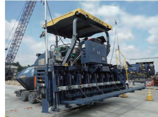
通常のアスファルトフィニッシャは平滑な舗装路面をつくる機械ですが、3D-AFは、あえて舗装面に凹凸を生じさせた「悪路」をつくるなど、あらゆる形状の路面を形成するために開発されたアスファルトフィニッシャです。主に自動車関連企業やタイヤメーカーが、自動車の耐久性やタイヤの性能を評価するためのテストコースなどで使用されています。お客様のニーズに応じた形状の路面をつくることはもちろん、世界各国の規格に対応した道路をつくることも可能です。当社の技術であらゆる形状の路面を再現し、自動車の安全性向上やタイヤの性能向上により交通事故の削減に貢献します。また、従来工法に比べて、大幅な工期短縮やコストダウンなどのメリットもあります。
