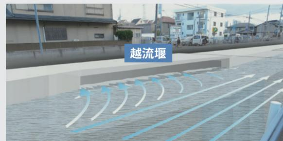
1 河川護岸より低い越流堰を設置
