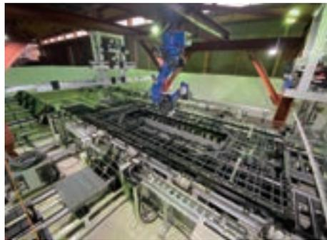
鉄筋組立自動化システム「Robotaras™」
