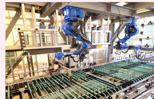
鉄筋組立自動化システム「Robotaras<sup>®</sup> II」
