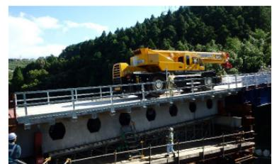
実証橋のクレーン載荷試験
