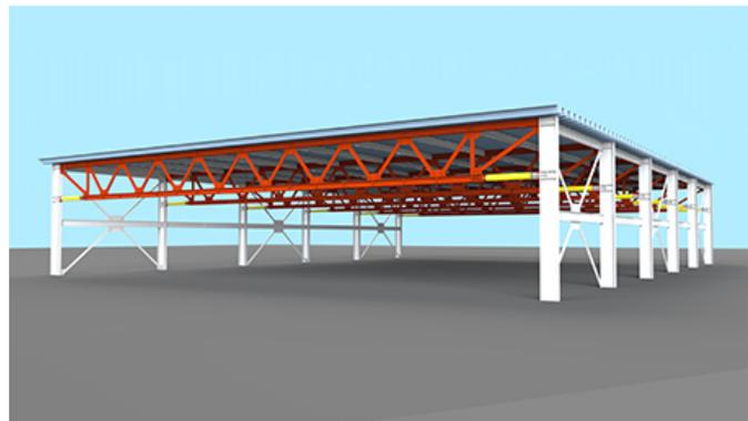
損傷制御型トラス梁構法「雷靱 (RAIJIN)™」
