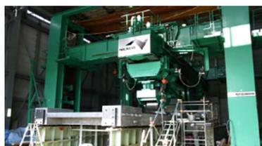
床板の輪荷重走行試験
