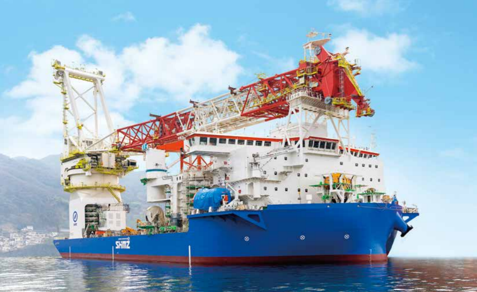
洋上風力発電所建設用のSEP船 ® (建造中) ※ Self-Elevating Platform:自己昇降式作業船
