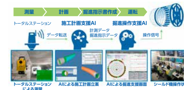
AIを活用したシールドトンネル施工 東京国際空港際内トンネル他築造等工事(東京都大田区)
