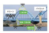
ドローンにより撮影したデータや赤外線カメラ画像をAIで解析し、錆やコンクリートのひび割れを検出
