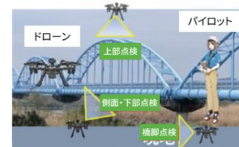
ドローンにより撮影したデータや赤外線カメラ画像をAIで解析し、錆やコンクリートのひび割れを検出
